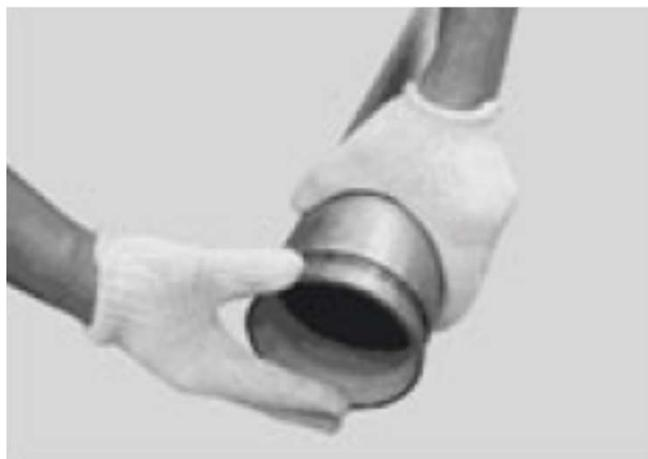
① 溝付近シール面の外径、変形、汚れ、疵、錆、ライニング、塗装の確認
