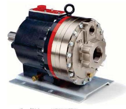
ポンプ型式: G35XKSGHFEHH 流量: 120~140LPM 圧力: 7.0~8.3MPa
